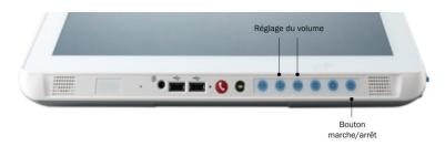
Appuyez sur le bouton marche/arrêt situé dans le coin inférieur droit du terminal de chevet intégré (TCI).
